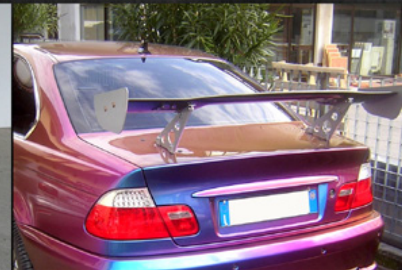
ALUN0301 - Alettone Atomyc con ala in vetroresina | Fiberglass wing Atomyc ALUN0302 - Alettone Atomyc con ala in carbonio | Carbon wing Atomyc
